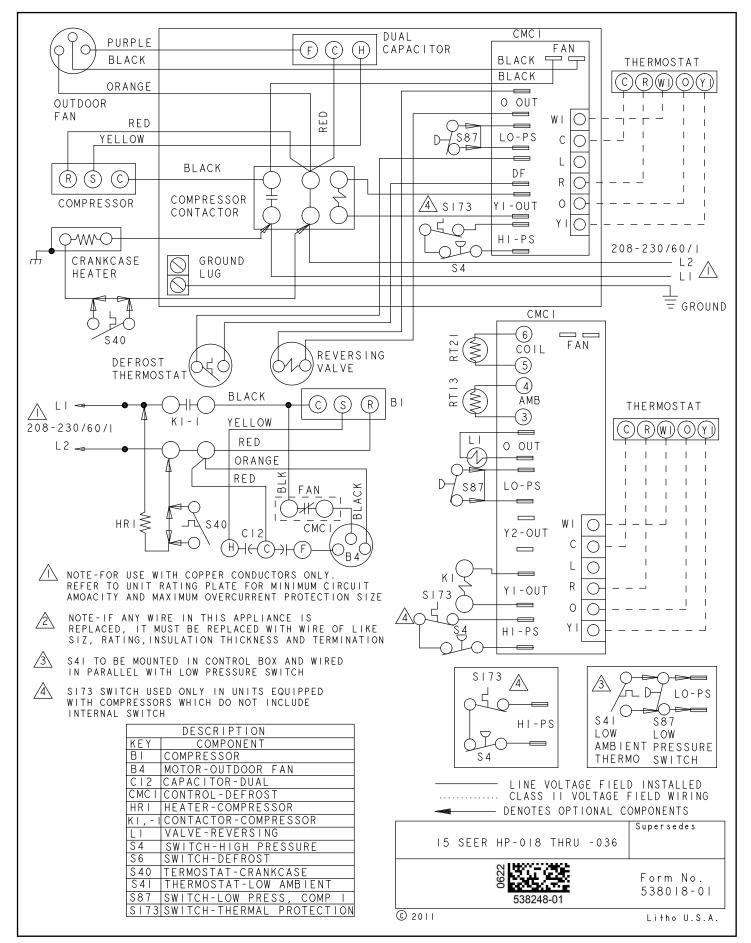
Figure 13. Wiring Diagram 018 - 036 Models
